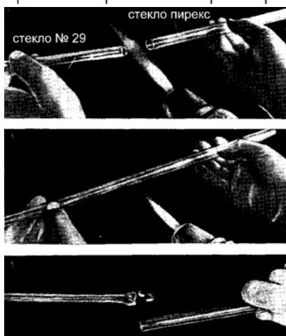
Рис. 62. Влияние коэффициента расширения стекла на прочность спая: а — трубки из разного стекла; б—спаивание трубок при разогревании и размягчении; в — разрушение трубок по спайке с отрывом осколка стекла.
