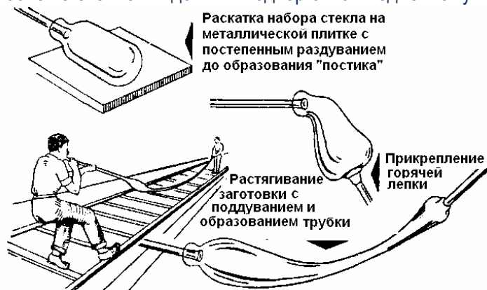
Рис. 13. Изготовление трубок ручным способом.
